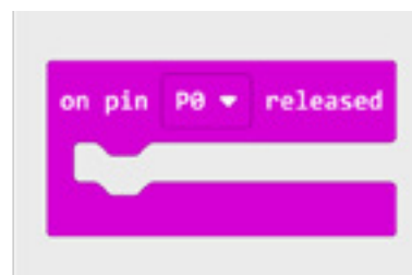
Pokreće obrađivač događaja (dio programa koji će se pokrenuti kada se nešto dogodi, na primjer kada se pritisne dugme).
